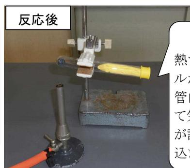
ガスバーナーで加熱する。スチールウールが燃焼すると試験管内の酸素が使われて気圧が下がり、風船が試験管の中に吸い込まれる。
