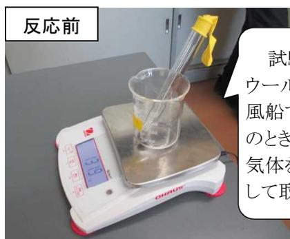
試験管にスチールウールと酸素を入れ、風船でふたをする。このとき風船の中には気体を入れないようにして取りつける。
