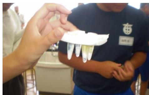
発泡ポリスチレンボードに固定したマイクロチューブ
