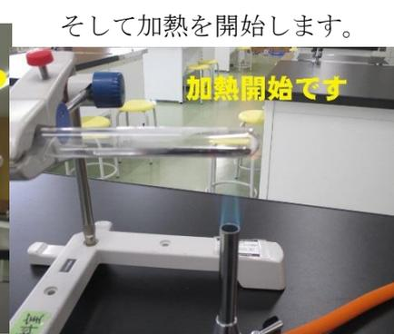
加熱部が透明になります。少しずつガスバーナーをずらしていくと、ガラス棒全体が透明に戻ります。
