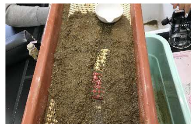
レゴブロックを使って護岸ブロックをモデル化した実験
