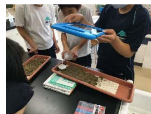
レゴブロックを使って護岸ブロックをモデル化した実験
